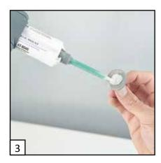
Applizieren Sie eine kleine Menge Klebstoff auf die Unterseite des Weld Mount Befestigungselements.
